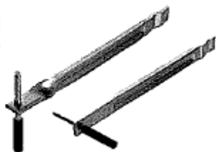
Fig. 8 Rørformet bæreanker til indmuring i udsparing i betonvæg (Halfen UMA. Ved moderne montager skal rørankrene være forholdsvis lange, da de skal indstøbes ca. 100 mm, og isoleringen fylder måske 200 mm.
